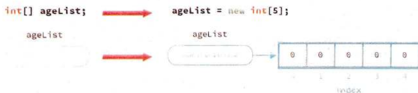
Schemadarstellung im Speicher: Deklaration des Arrays ageList (links), Instanzierung und implizite Initialisierung des Arrays ageList mit Nullen (rechts).
